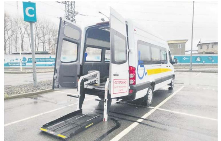
Все внутренние поверхности кузова закрыты пластиковыми панелями. Высота салона составляет 1870 мм. Внутри предусмотрены места с креплениями для двух инвалидных кресел, а также три сидения для сопровождающих, смонтирован дополнительный автономный обогреватель.
