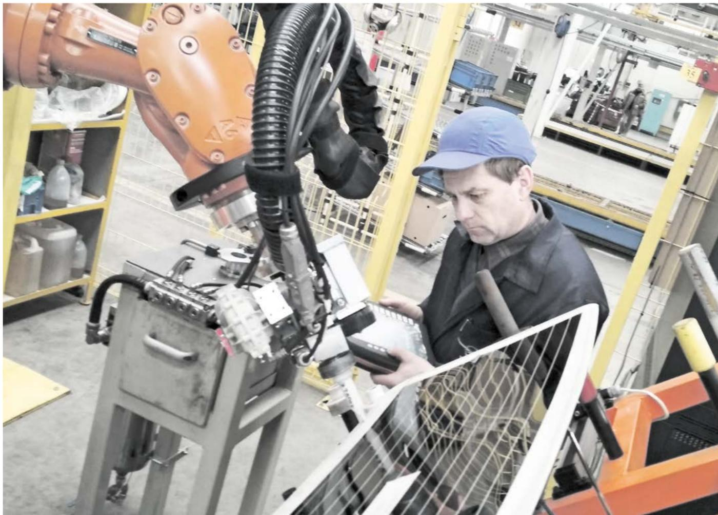
► **Корректировка траекторий движения робота нанесения клея на стекла автомобиля (Производство сборки и сдачи автомобилей ООО «УАЗ»)**
