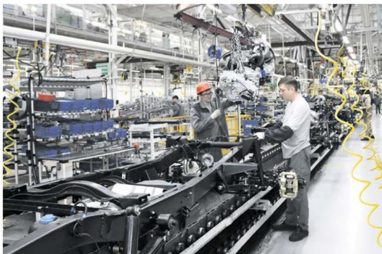
► Рама автомобиля на главном конвейере
