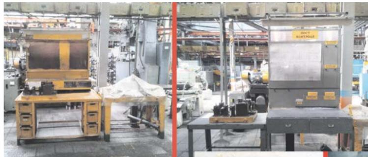
► Контрольный пост с ящиками для хранения контрольно-измерительных инструментов. Слева – до оптимизации, справа – после.
