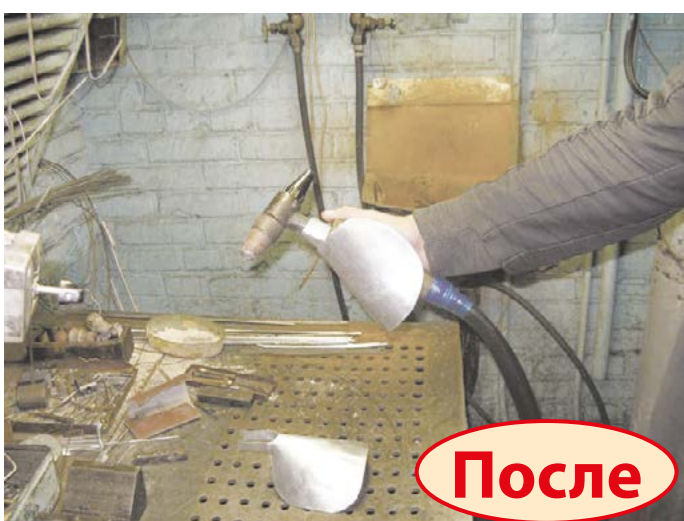
На горелку для наплавки ножей изготовлен защитный экран, сделанный из неликвидов производства, для защиты руки от высокой температуры.
