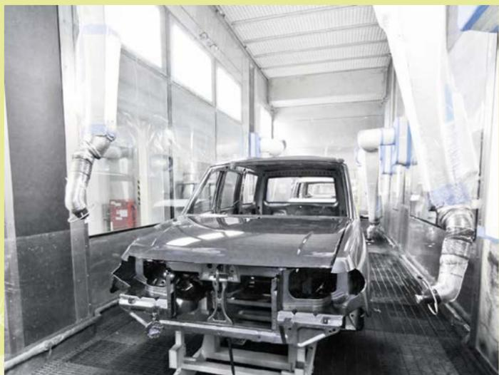
На предприятии завершена модернизация роботизированной линии окраски кузова. Переход с пневматического метода нанесения краски на электростатический позволил снизить себестоимость окраски кузовов за счет повышения эффективности нанесения базовых эмалей.
