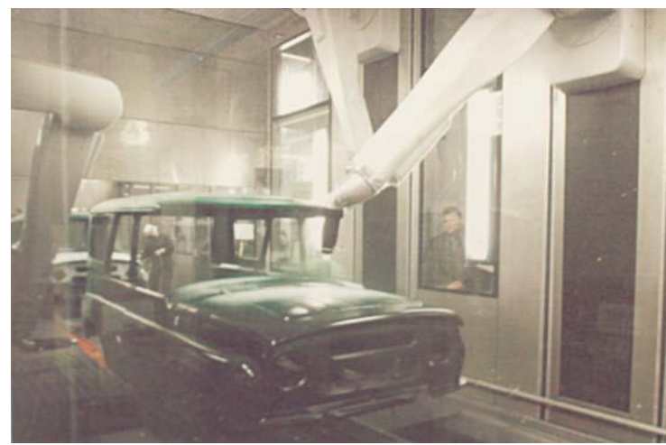
» Роботизированная линия окраски. 2005 год.
