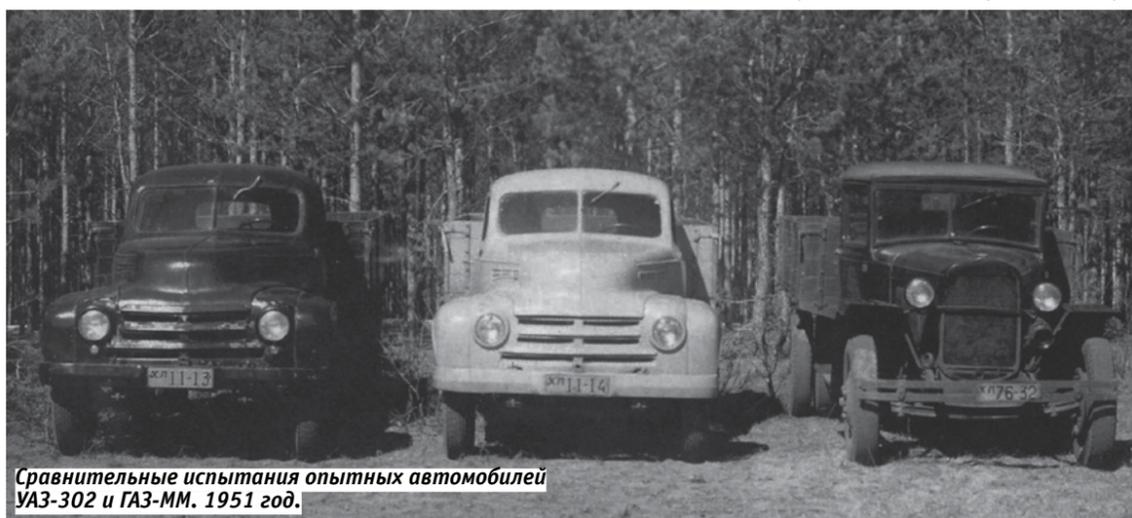
Сравнительные испытания опытных автомобилей УАЗ-302 и ГАЗ-ММ. 1951 год.
