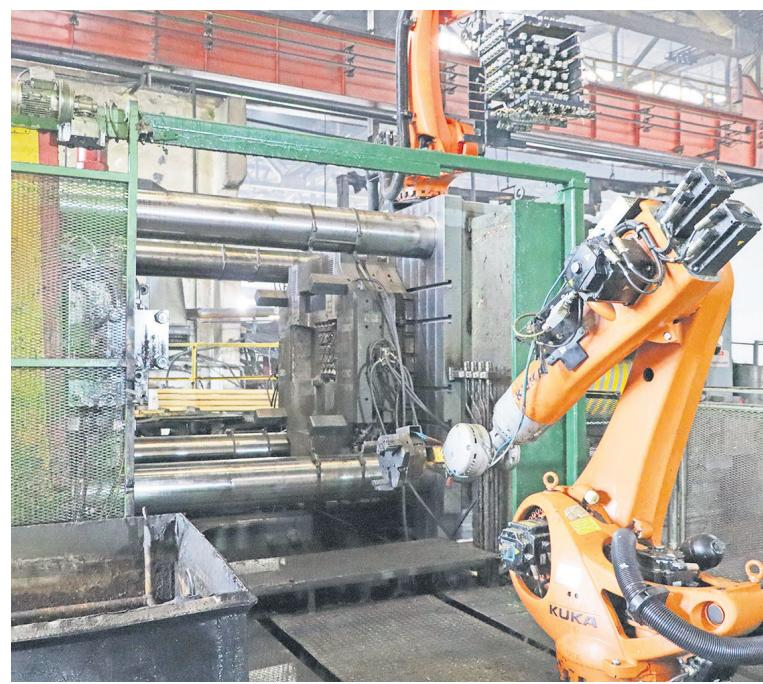
В ходе ремонтных работ произведены замена неподвижной плиты и всех четырех направляющих колонн механизма запирания, а также другие работы: замена дозатора металла, изменение прокладки электрокабелей, замена магистралей охлаждения пресс-форм, ремонт регулирующих положение траперсы устройств, замена защиты направляющих, частичная замена клапанов и ремонт установок термостатирования и прочих исполнительных механизмов.
