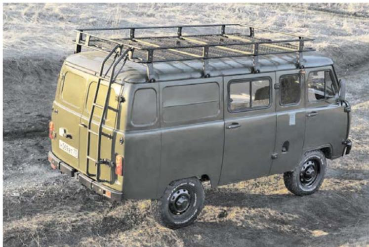
От стандартных модификаций «Буханка» Комби Трофи отличается внедорожными шинами BFGoodrich All-Terrain размерностью 225/75 R16, стальными дисками черного цвета и защитным колером кузова. Кроме того, версия Трофи выделяется экспедиционным багажником на крыше, лестницей на задней двери и ручками дверей нового типа.
