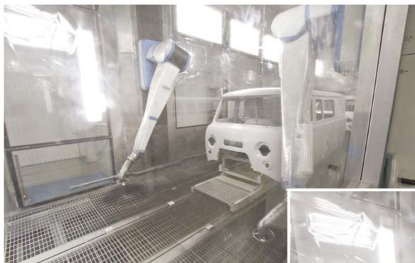
качество переноса материала, поскольку при его использовании почти все заряженные частицы краски прилипают к поверхности кузова, за счет чего коэффициент переноса материала увеличивается до 90%.
