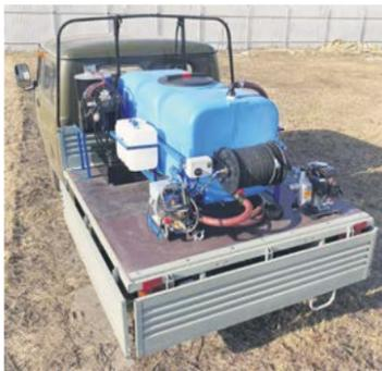
рабочего раствора (50 м), брендспойт типа пистолета с распылителем, армированный заборный шланг для заполнения основной цистерны (6 м) и бензогенератор для питания оборудования с возможностью запуска как от стартера, так и вручную.
