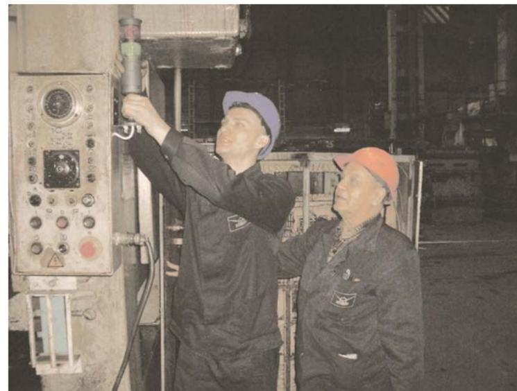
в настоящий момент находится оборудование: в режиме наладки, в рабочем режиме или есть неисправность.
