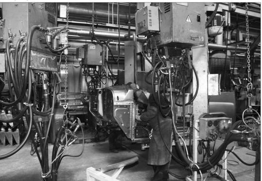
Внастоящее время проводится модернизация автоматических линий сварки основания, боковин и линии сварки кузова для выпуска обновленного UAZ Patriot, a также некоторых сварочных кондукторов. Выполнена модернизация кондукторов сварки распашной задней двери, рамок боковин и крыльев кузова. Под четким руководством технологов в июле были сварены первые опытные пять кузовов UAZ Patriot-2014. Согласно утвержденному графику к концу
