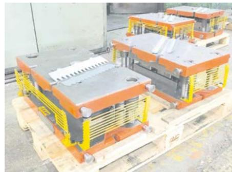
Габаритные размеры каждого штампа: 780 мм x 450 мм x 270 мм. Вес — 350 кг.
