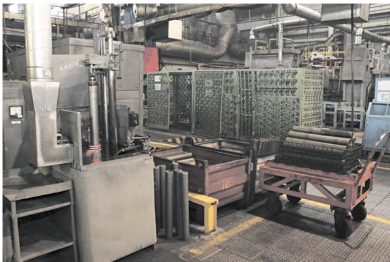
► На фото участок установок ТВЧ, где происходит закалка деталей при помощи тока высокой частоты. В данный момент обрабатываются рукава мостов для УАЗ ПРОФИ. О высокой культуре производства говорит то, что складирование самих деталей происходит согласно всем схемам, посторонние предметы вокруг рабочего места отсутствуют. Это влияет и на качество продукции, и на безопасность рабочего.
